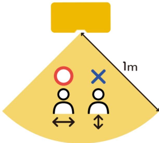
センサの白い窓の前から1mの範囲を、熱を持つ物体が横切る動きを検知します。
