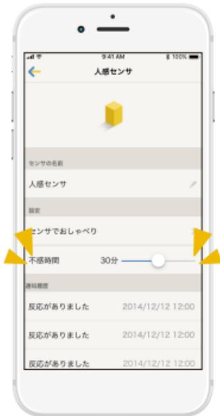
センサが一度反応してから、次に反応するまでの時間を30秒から60分の間で設定できます。
