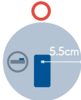
磁石とセンサが一番近づくと、磁石が白い点を中心とした半径5.5cmの円の中に収まるように取り付けてください。
